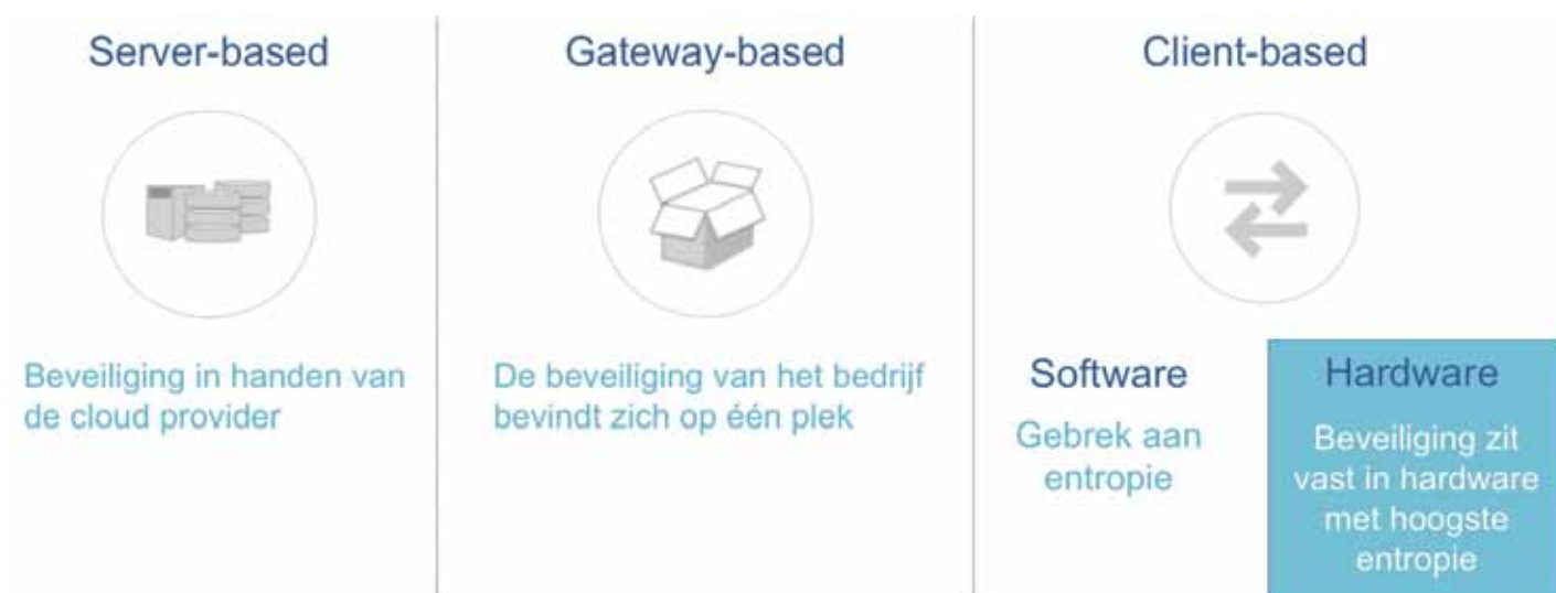
Figuur 1. Encryptiesystemen voor het beveiligen van data in de cloud kunnen opgedeeld worden in drie categorieën
