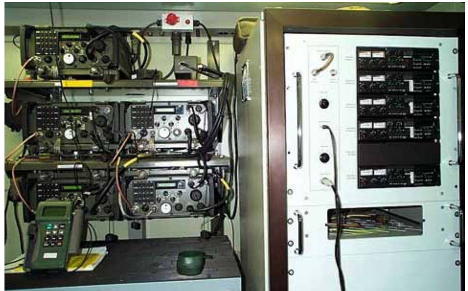
ECCM pel met analoge opname apparatuur nadat de eerste verbouwing aan de shelters had plaatsgevonden. Rechts de opname cassette recorder waarop bij iedere opname met een microfoon moest worden ingesproken welk radionet op dat moment bij welke recorder hoorde.
