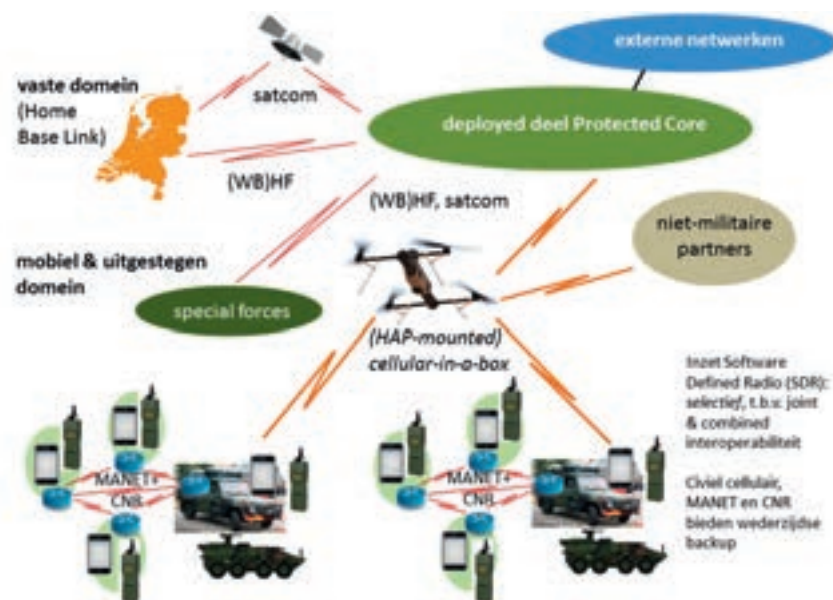
Mogelijke systeem-invulling van de NII communicatiecomponent (joint en combined verbindingen niet expliciet aangegeven)
