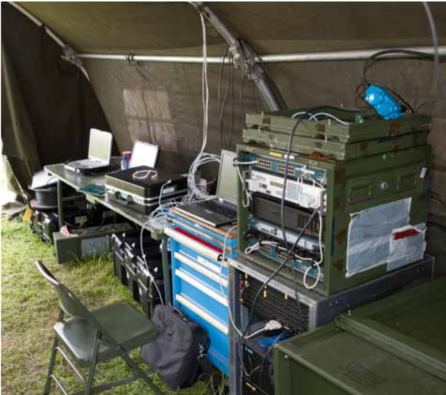
Het meest in het oog springend: de HBL KLu box (midden bovenop), met daaronder de Realitis (moveable) telefooncentrale. Uitloper C2VN en MDTN tentopstelling HBL KLu.
