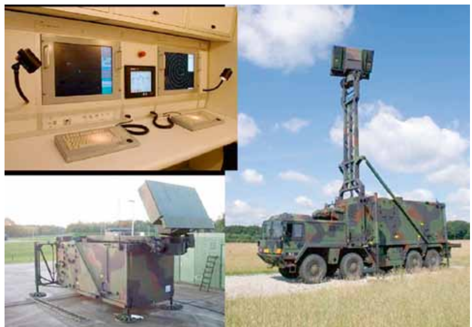
De radar TRML-3D/32 op het voertuig, van het voertuig af en de bedieningsruimte
