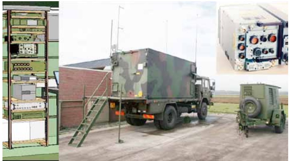
Het commsvoertuig met 19" rek (links) en Link 16 terminal (rechts)
