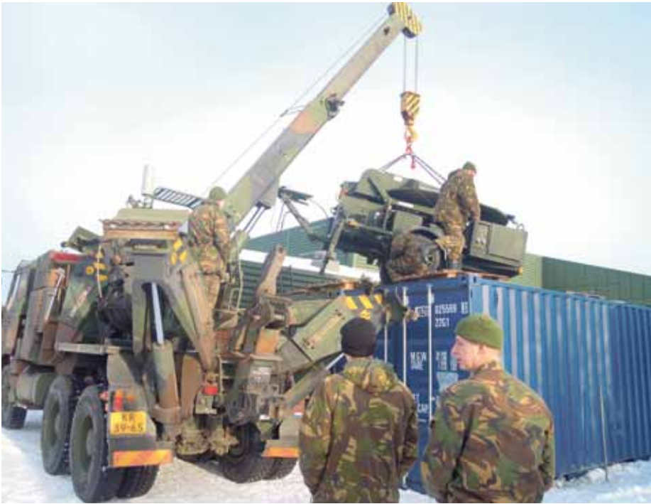
Figuur 4: De tactische trailer wordt op de zeecontainers geplaatst
