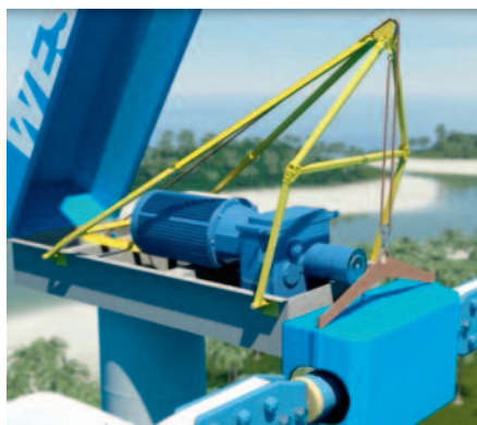
Afbeelding 4: WES de mast wordt als kraan gebruikt
