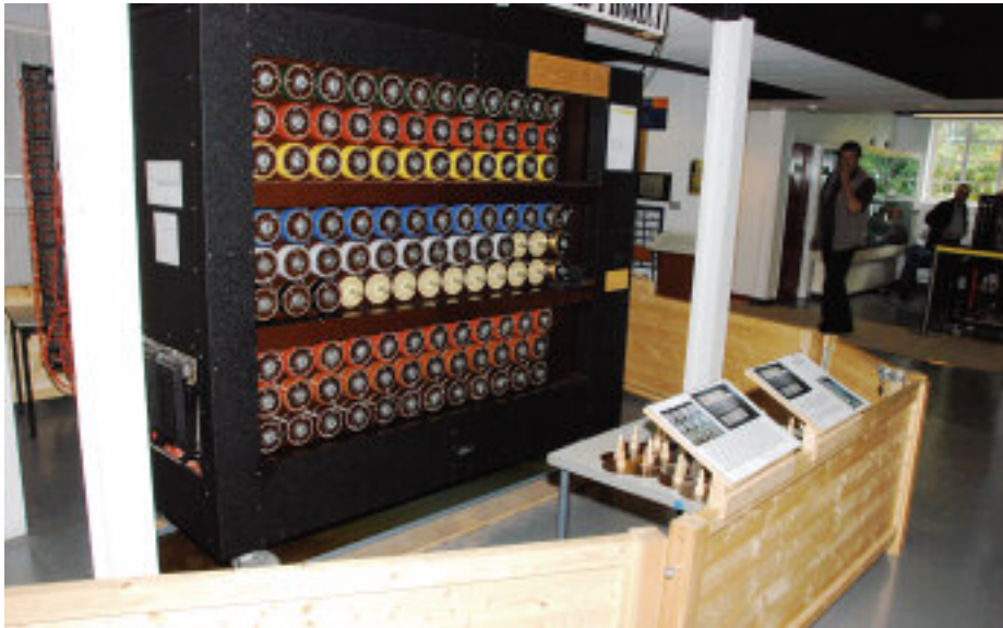
Afbeelding 6 Een replica van de zogenaamde Bombes waarmee men in Bletchley Park de Enigmacode kon breken (foto Paul Reuvers)
