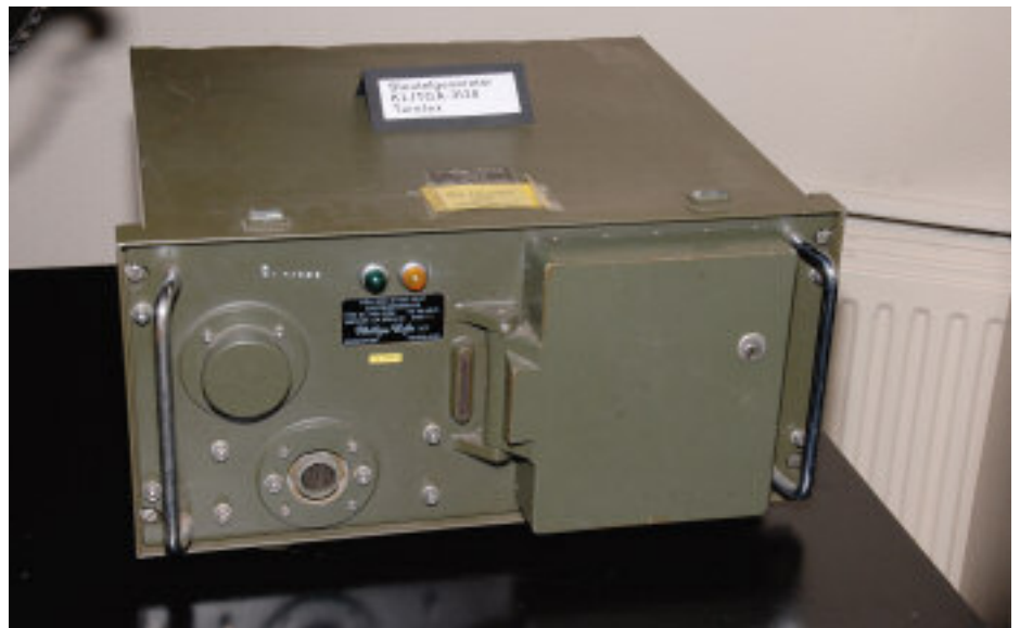
Afbeelding 10 De Tarolex maakte de cryptoband overbodig. In 1966-1967 werden 150 Ecolex 4 hiervoor omgebouwd (foto Paul Reuvers)
