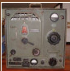
Duitse LS 100/108, 100 Watt Langwellen Sender (200 - 1200 KHz) voor spraak en telegrafie
