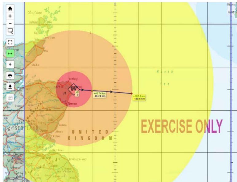
Figuur-7: Simulatie van het effectief bereik van een 200W GPS jammer op 3m boven Mean Sea Level
