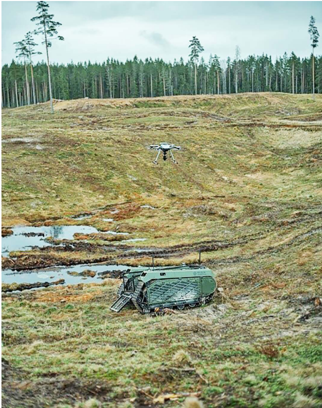
Foto 4: een tethered drone op een THeMIS
